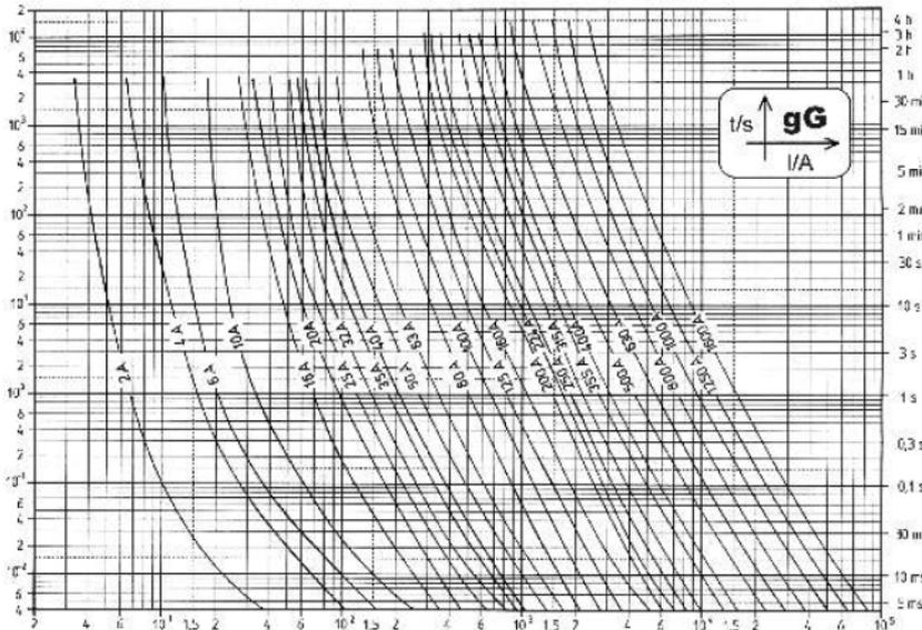
Die mittleren Zeit-Strom-Kennlinien gelten bei einer Umgebungstemperatur von  $20 \pm 5^\circ\text{C}$  und den in den Vorschriften für den Prüfbau zugeordneten Kabel-(Leitungs-)Querschnitten.
