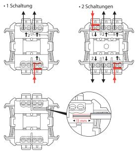
Selbstklemmende Anschlüsse Die Klemmenweite beträgt 1,5 mm² - 2,5 mm² (1 oder 2 Leiter).
