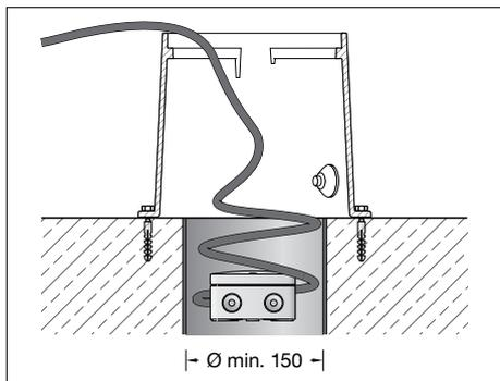
Für das Herausnehmen der Leuchte ist im Einbaugehäuse eine Leitungslänge von 0,5 m vorzusehen.
