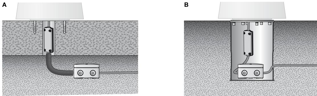
Montage auf einem bauseitig erstellten Fundament oder einer anderen befestigten Fläche (Abb. A):
